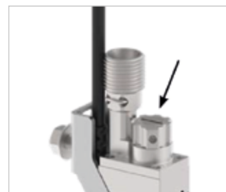
Тонкая настройка подачи клея шлицевой отверткой
