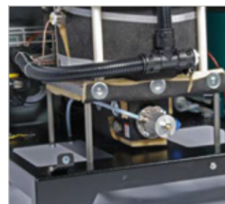
Клапан ограничения давления со встроенным фильтром тонкой очистки
