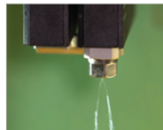
Взаимодействие распыляющего воздуха и подаваемого клея
